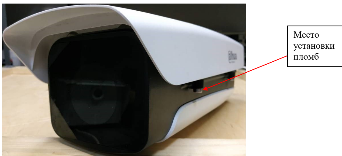
Рисунок 2 - Общий вид распознающей видеокамеры комплексов и место установки пломб
